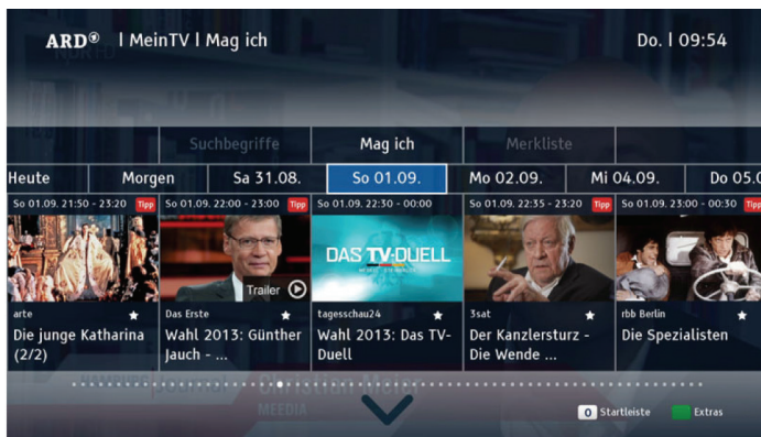
Slika 18.9. Napredni EPG u okviru HbbTV aplikacije nemačke televizije ARD
