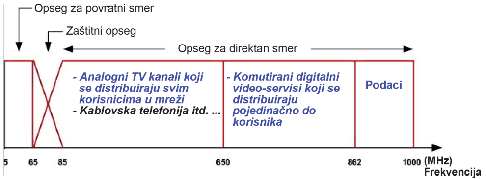
Slika 16.1. Frekvencijski opseg KDS-a za direktni i povratni smer
